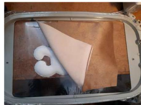
Stabilizzatore a strappo nel telaio – Ricamo la traccia di posizione
